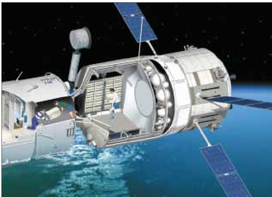
Un ATV permanece unido a la ISS, proporcionando espacio presurizado adicional para la estación.
