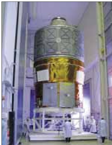
Modelo STM, totalmente ensamblado.
