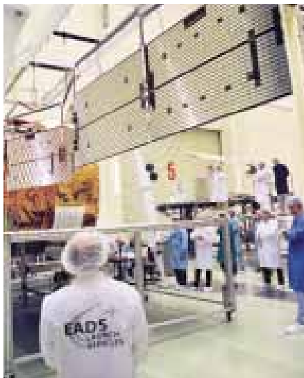
Prueba de despliegue de los paneles solares
