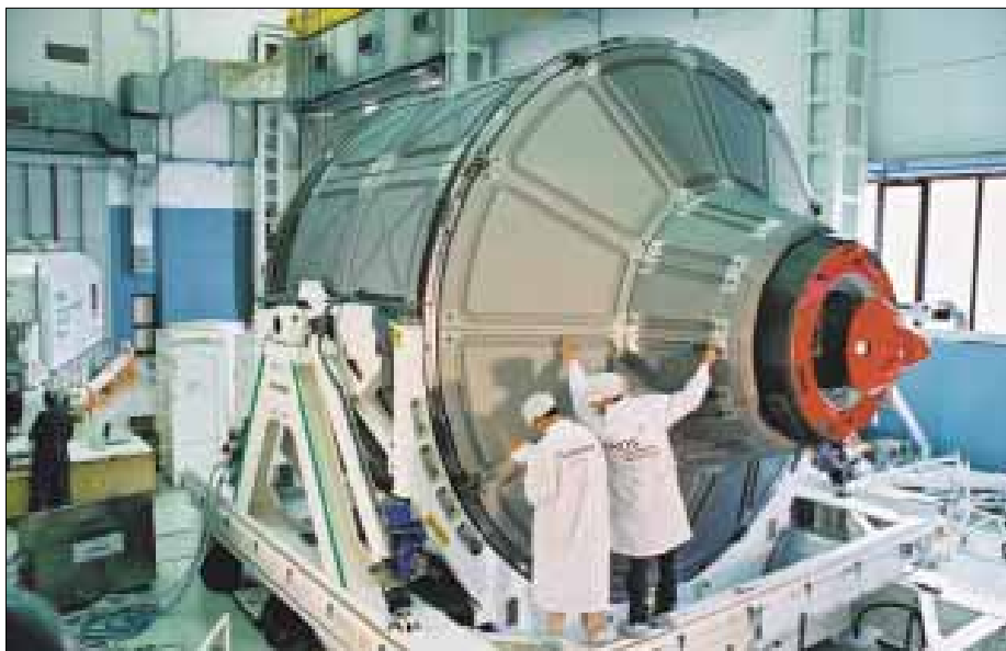
Zona de acoplamiento del módulo presurizado del ATV.
