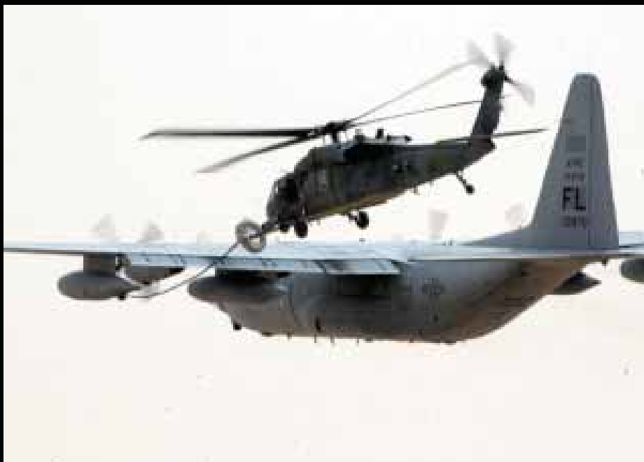
Helicóptero HH-60G Pavehawk de operaciones especiales realizando un reabastecimiento en vuelo con un KC-130 en el sur de Irak el 6 de abril.
